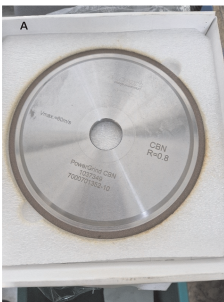
Rys. 6. Ściernica supertwarda ze spoiwem metalowym PowerGrind CBN firmy Loroach: a) widok ogólny, b) ściernica zamocowana we wrzecionie szlifierki
