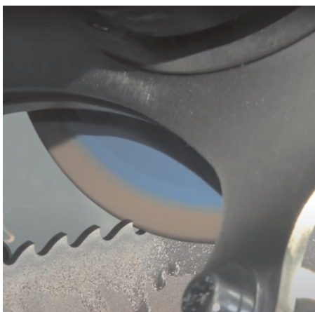
Rys. 5. Nacinanie zębów ściernicą supertwardą z CBN
