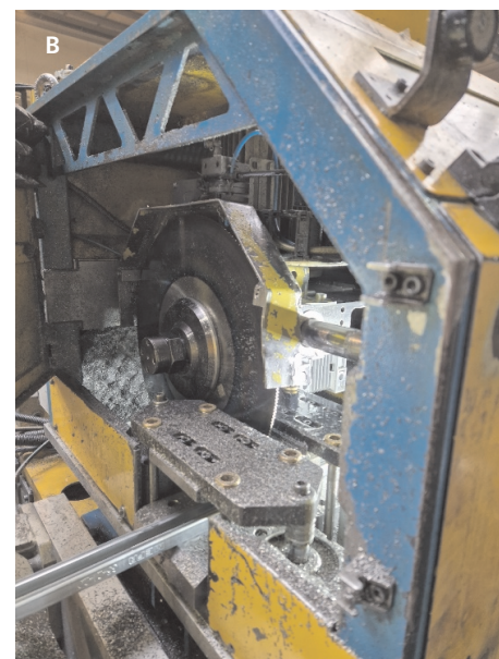
Rys. 9. Stanowisko do cięcia profili: a) widok ogólny pily GTF450 produkcji firmy MFO S.A., b) strefa robocza z widocznym frezem tarczowym tnącym profil stalowy
