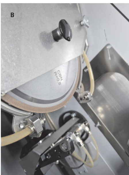
Rys. 6. Ściernica supertwarda ze spoiwem metalowym PowerGrind CBN firmy Loroach: a) widok ogólny, b) ściernica zamocowana we wrzecionie szlifierki
