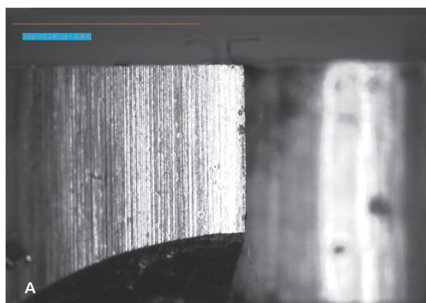
Rys. 8. Profil stalowy wykonany ze stali konstrukcyjnej S320GD z powłoką antykorozyjną Magnelis ZM310: a) przekrój poprzeczny, b) widok
