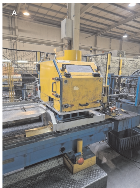
Rys. 9. Stanowisko do cięcia profili: a) widok ogólny pily GTF450 produkcji firmy MFO S.A., b) strefa robocza z widocznym frezem tarczowym tnącym profil stalowy
