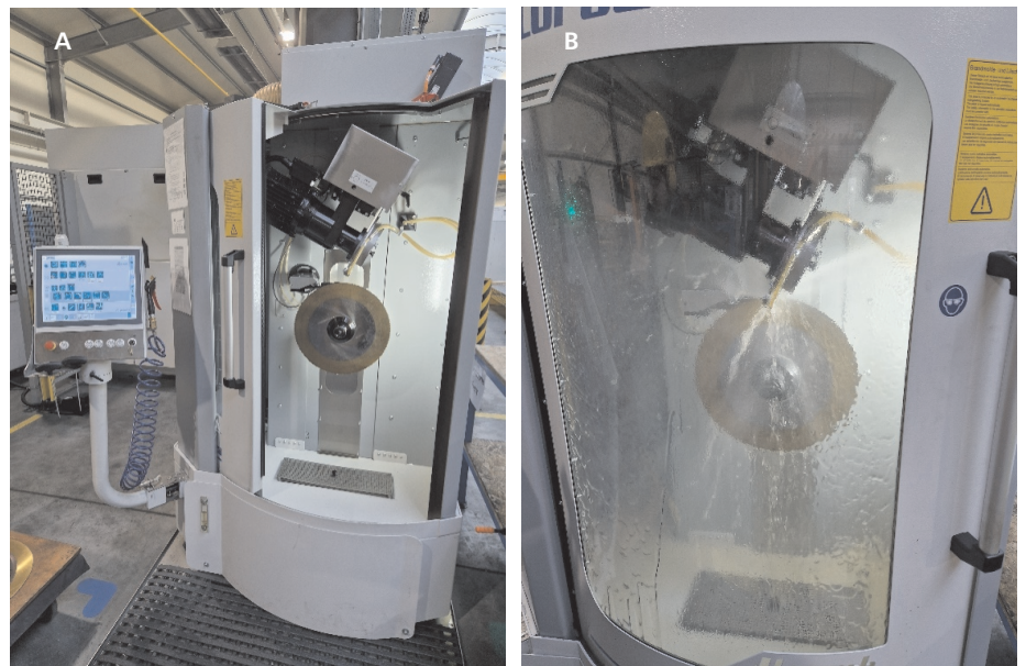
Rys. 3. Widok pięcioosiowej szlifierki CNC do ostrzenia frezów tarczowych firmy LOROCH GmbH (Mörtenbach, Niemcy) model Solution K850-T: a) widok ogólny, b) komora robocza szlifierki podczas pracy
