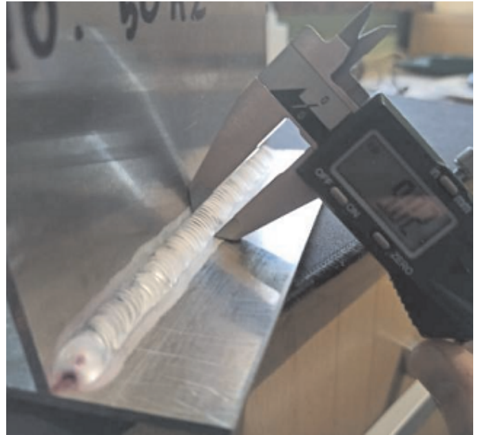
Rys. 5. Sposób pomiaru szerokości spoiny
