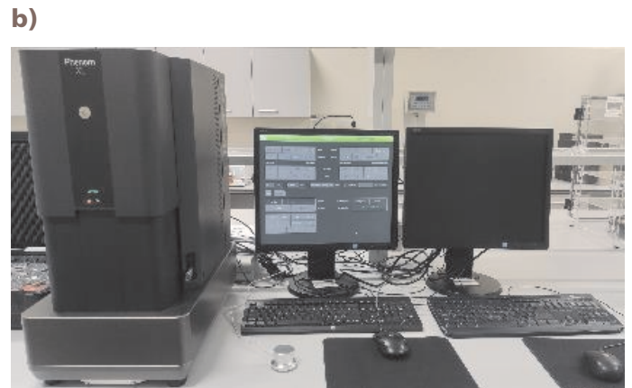
Rys. 2. Elementy stanowiska badawczego: a) mikroskop Leica DCM8, b) skaningowy mikroskop elektronowy Phenom XL
