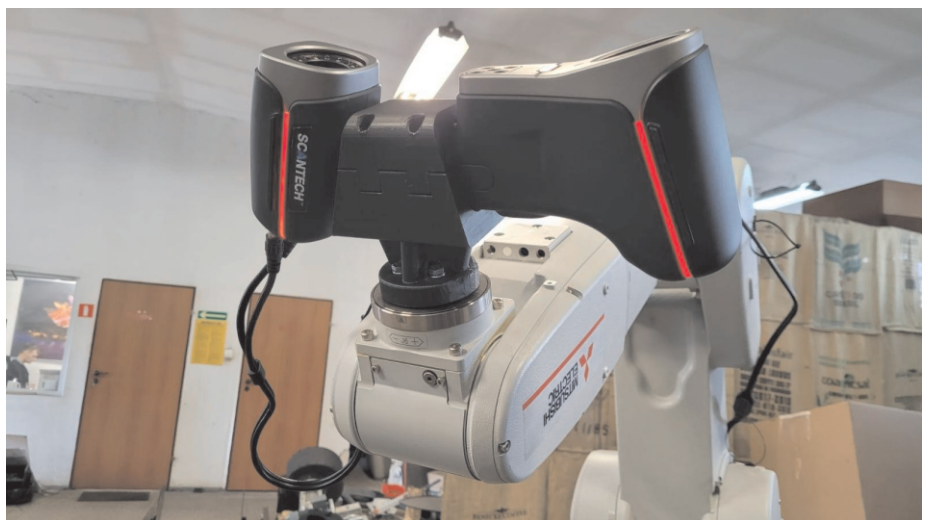
Rys 3. Uchwyt łączący ramię robota ze skanerem 3D wydrukowany za pomocą drukarki 3D [8]
