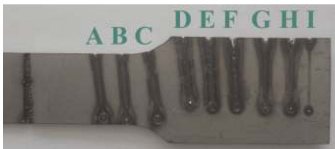
Rys. 3. Widok przetopów imitujących spoinę (próba testowa)
