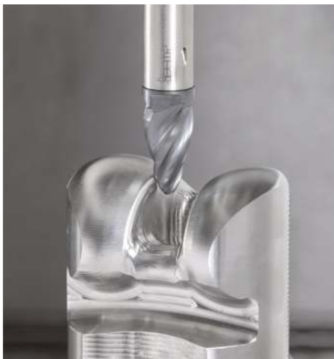
Rys. 4. Zastosowanie małego frezu barytkowego znacząco redukuje czas cyklu obróbki protezy kolana
