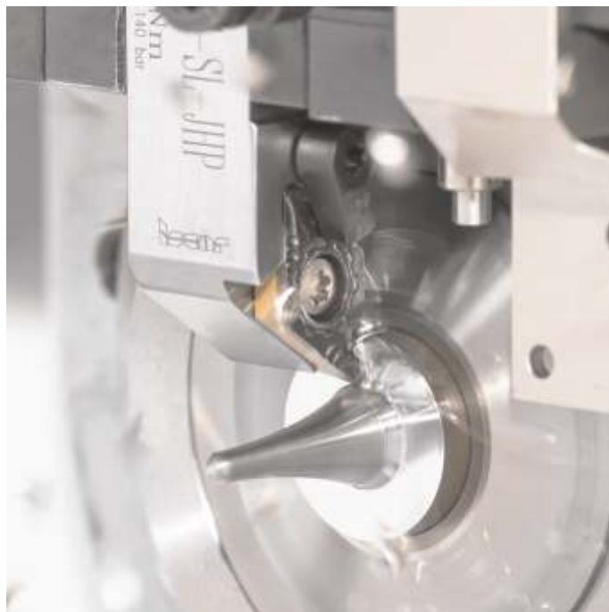
Rys. 2. Wytrzymała konstrukcja oraz doprowadzenie chłodziwa pod wysokim ciśnieniem charakteryzują tokarskie oprawki SAFE-T-LOCK
