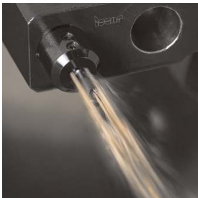
Rys. 1. Ulepszone doprowadzenie chłodziwa zwiększa efektywność toczenia za pomocą miniaturowych narzędzi PICCOCUT
