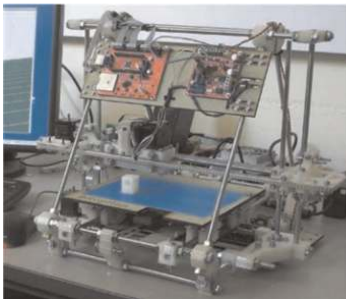
← Rys. 1. Drukarka RepRap – tania alternatywa dla komercyjnych, drogich drukarek 3D [6]
