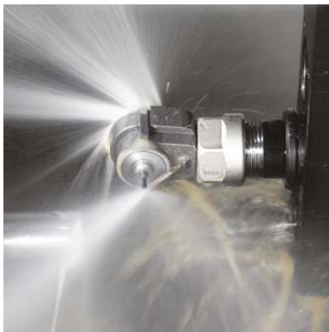
Rys. 5. Kompaktowa oprawka MICRO90 napędzana chłodziwem to efektywne narzędzie do zwiększenia prędkości obrotowej miniaturowych narzędzi skrawających
