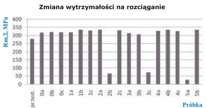
Rys. 14. Zbiórce wyniki wytrzymałości na rozciąganie dla wszystkich próbek
