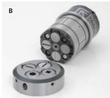
Rys. 9. Rewolwerowy 16-pozycyjny magazyn narzędzi: a) widok ogólny, b) indywidualne narzędzie [6]
