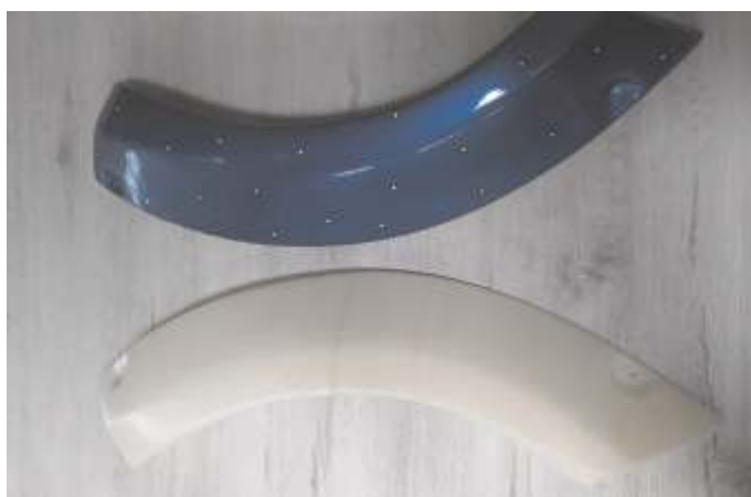
Rys 4. Dokładki nadkola samochodowego odwzorowane przy użyciu skanowania 3D i wykonane technologią drukowania 3D [8]
