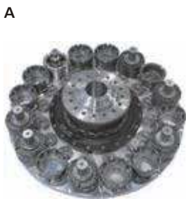
Rys. 9. Rewolwerowy 16-pozycyjny magazyn narzędzi: a) widok ogólny, b) indywidualne narzędzie [6]
