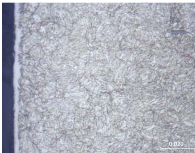
Rys. 7: Fotografia mikrostruktury strefy przypowierzchniowej jednej z próbek; trawiono nitaliem
