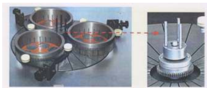
Rys. 2. Układ wykonawczy docierarki jednotarczowej z wymuszonym napędem pierścieni prowadzących [6]
