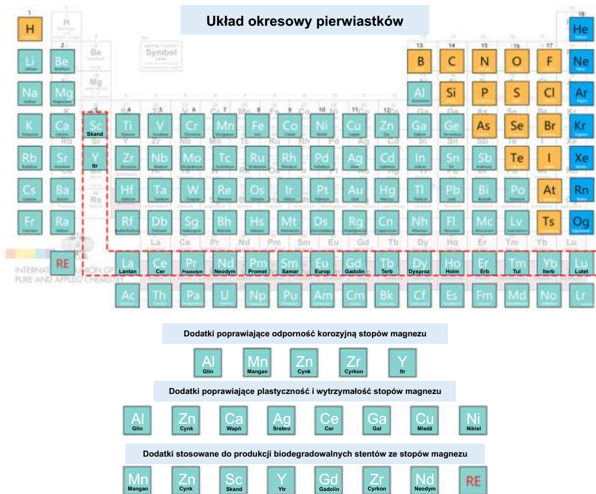
Rys. 1. Elementy stopowe poprawiające odpowiednie właściwości stopów magnezu; RE – (Rare Earth) – pierwiastki ziem rzadkich; wg [12]
