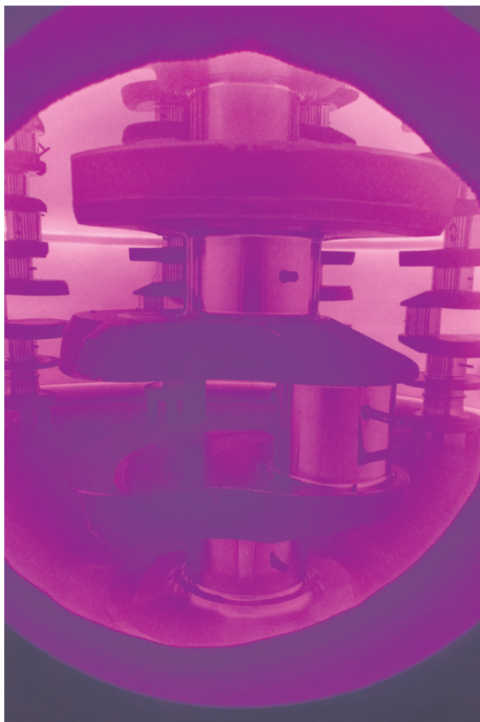
Rys. 1: Podgrzewanie wstępne obciążonych wałów korbowych z ekranami katody
